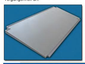
Unsere fugenlose Platte ist bis zu einer Größe von 4000x2000mm in einem Stück herstellbar und kann nach Absprache auch projektbezogen angepasst werden. Die Plattenstärke kann je nach vorhandener Stützweite z.B. 20/40mm oder 35/50mm betragen, dabei richtet sich die zulässige Stützweite der Unterkonstruktion immer nach der geringsten Plattenstärke.
