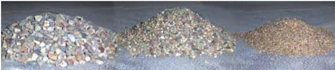
*mineralit<sup>®</sup> ist ein Hochleistungs- Verbundwerkstoff, der zu 94 % aus natürlichen Quarzsanden besteht (s. Bild), die mit einem hochwertigen, selbstvernetzenden Acrylharz gebunden werden. Aus diesem Material werden hochverschleissfeste Formelemente gegossen.*
