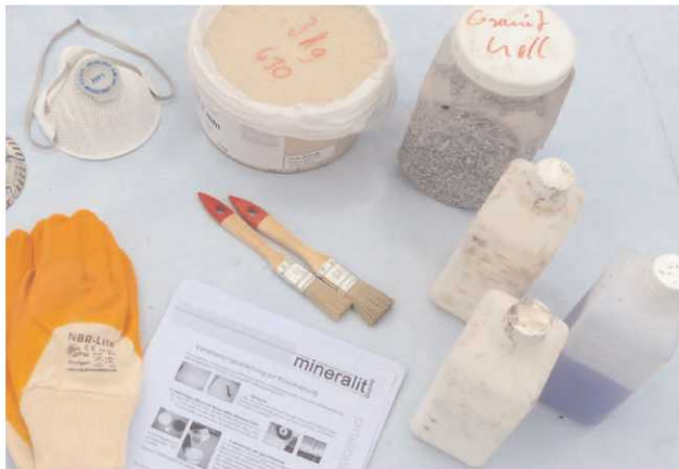
Grundmischung Quarzsande (3kg) , Acrylharz G12-20 (blau), Härter Pergan 50 W (Pulver weiß)
