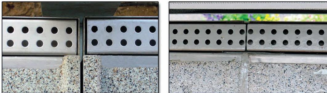
Die angegossene Edelstahl (V2A) Entwässerungsrinne kann sowohl stirn- als auch wandseitig oder seitlich, je nach Bauvorhaben individuell, ausgeführt werden. Selbstverständlich ist die Rinne an den Seitenenden geschlossen, sofern diese nicht bei geteilten Balkonplatten mit Verbindungselementen zusammengefügt oder mit Winkelstücken mehrseitig gefertigt werden soll.
