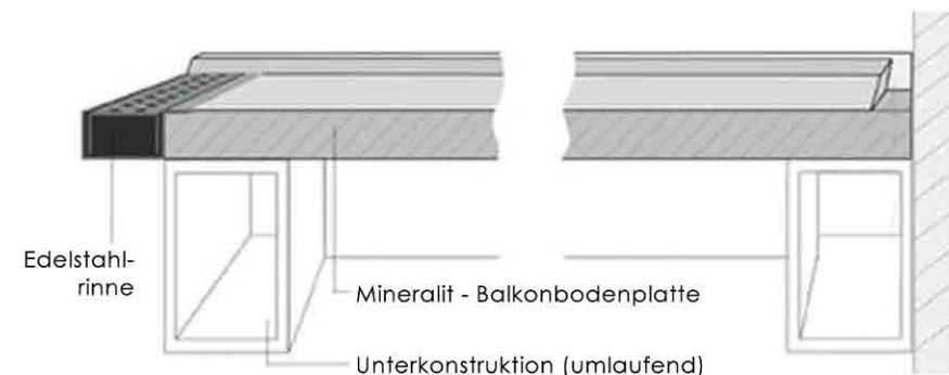
Die angegossene Edelstahl (V2A) Entwässerungsrinne kann sowohl stirn- als auch wandseitig oder seitlich, je nach Bauvorhaben individuell, ausgeführt werden. Selbstverständlich ist die Rinne an den Seitenenden geschlossen, sofern diese nicht bei geteilten Balkonplatten mit Verbindungselementen zusammengefügt oder mit Winkelstücken mehrseitig gefertigt werden soll.
