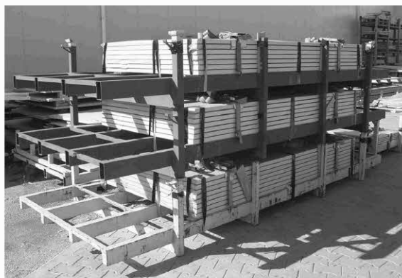
In Stahlleihpaletten verpackte Mineralit - Platten
