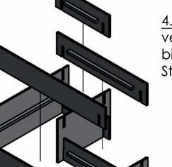
4. Schritt: verbleibende HB-Eck Steckteile-2-01 bis 03 an den entsprechenden Stellen von oben aufstecken
